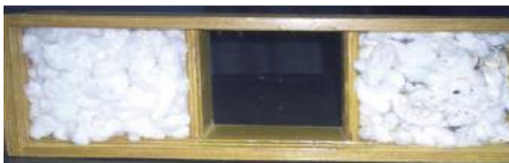
FIGURE 23 : BOITE DE STANDARD COTON-GRAINE : 1ER CHOIX A GAUCHE, 2EME CHOIX A DROITE ; LA CASE CENTRALE REÇOIT L'ECHANTILLON A CLASSER.
